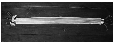
Foto 15: Ordening van stroom- en schakeldraden.
