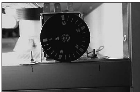
Foto 14: Zo kan men de thermostaat vast zetten op de tussenstang.
